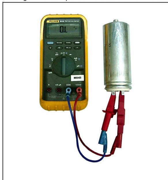
Si se escuchara un sonido prolongado o no se escuchara ningún sonido, significa que el condensador es defectuoso y debe reemplazarse.
