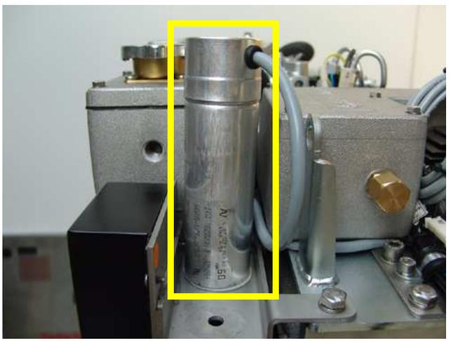
Fig. 3.3.6-20: Condensador de amplificación de 230 voltios/50 Hz
