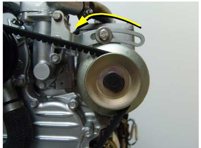
Alargue la correa en V y coloque el alternador nuevamente. La correa en V es la correcta si se puede presionar aproximadamente 1 cm con el dedo pulgar.
