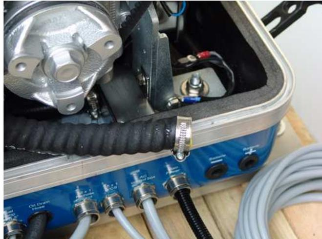
Fig. 10.3-5: manguera de refrigeración
