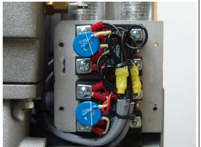
Fig. 3.3.6-22: Relés de estado sólido para condensadores de amplificación de 120 voltios/60 Hz
