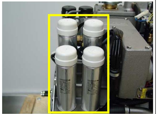
Fig. 3.3.6-21: Condensadores de excitación de 120 voltios/60 Hz
