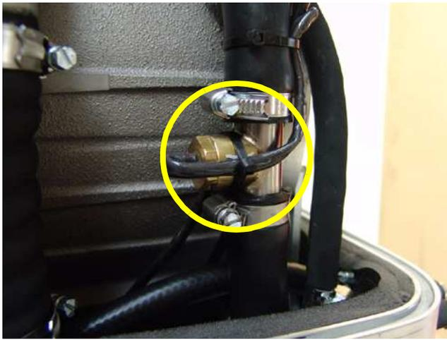
Fig. 3.3.7-5: Termocontacto de salida de agua salada
