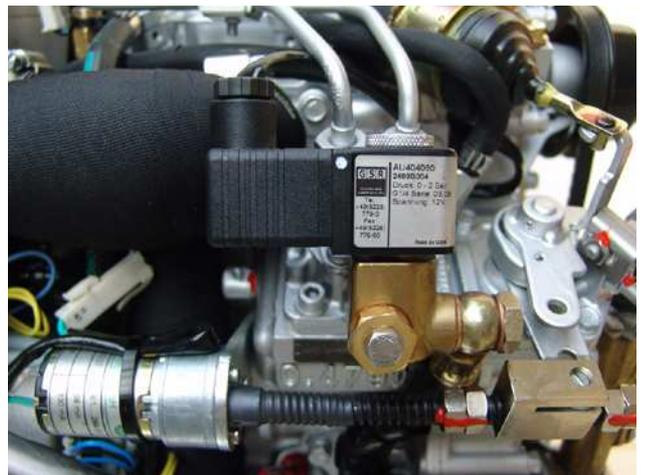
Fig. 5.6.5-1: Válvula solenoide de combustible
