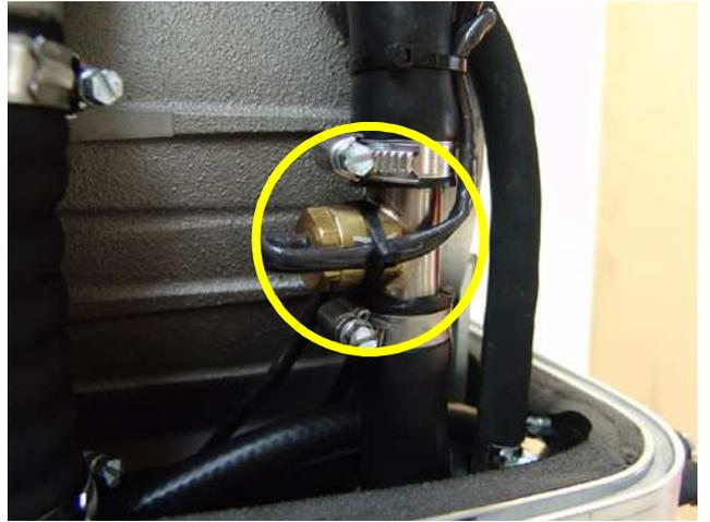
Fig. 4.1-5: Termocontacto de salida de agua salada
