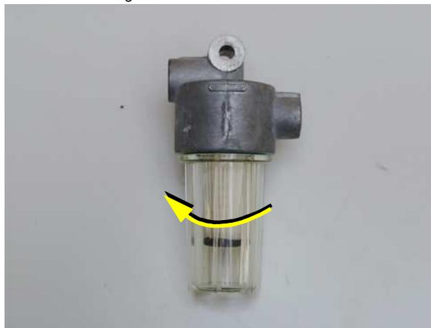
**Retire el elemento filtrante (02) de la cabeza de montaje (01).**
