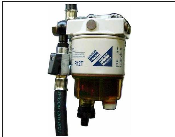
Fig. 5.6.4-1: Filtro de combustible con separador de agua
