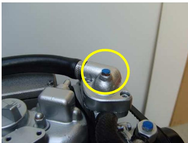
Fig. 3.3.3-10: Tornillo de ventilación de la tapa del termostato
