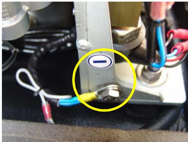
Fig. 5.7.1-2: Conexión del cable negativo de la batería de arranque
