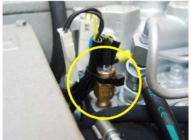
Fig. 3.3.7-1: Termocontacto en la culata
