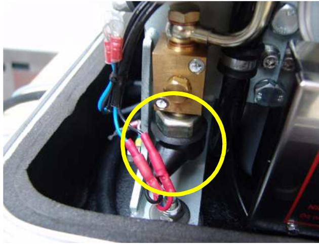
Fig. 3.3.7-10: Sensor de presión de aceite
