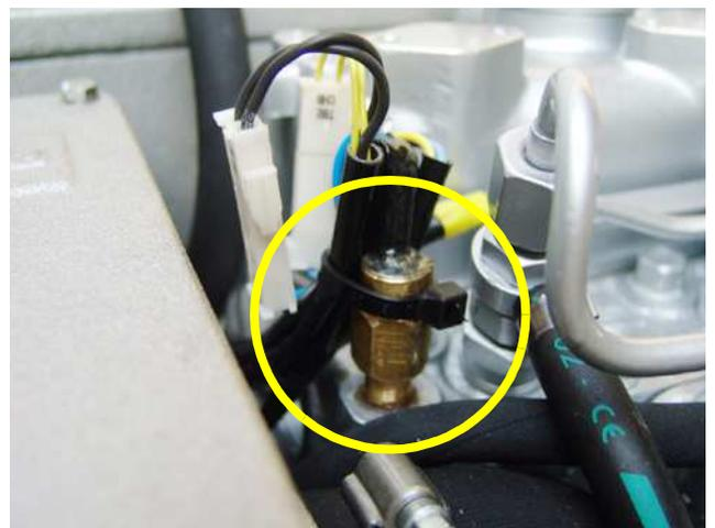
Fig. 4.1-1: Termocontacto en la culata
