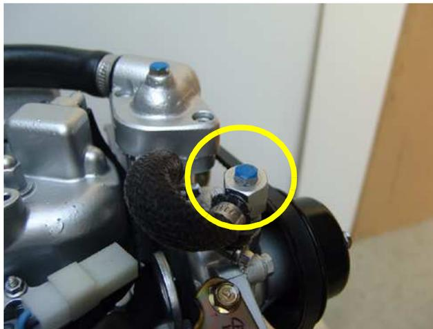
Fig. 3.3.3-9: Tornillo de ventilación de la bomba de agua refrigerante
