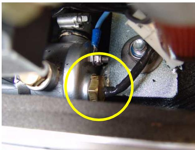
Fig. 4.1-4: Termocontacto de entrada de agua salada
