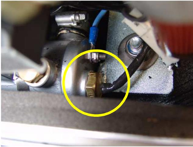
Fig. 3.3.7-4: Termocontacto de entrada de agua salada
