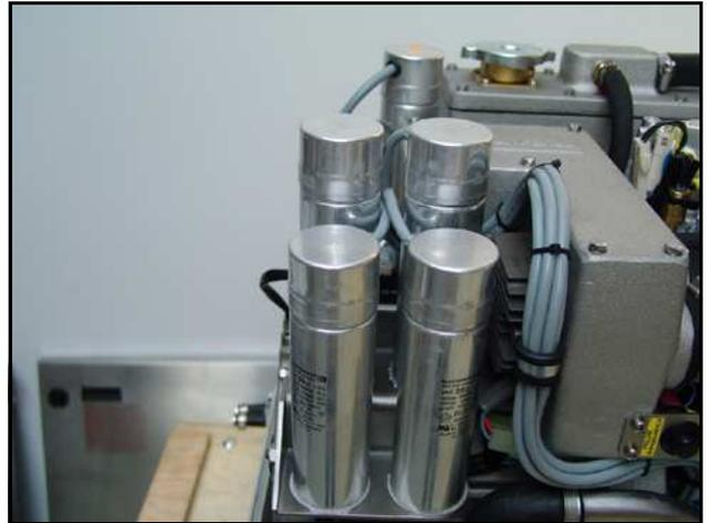
Los condensadores se descargan al poner en cortocircuito los dos contactos. Utilice además el extremo cónico de un destornillador aislado.
