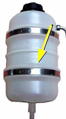
Ahora el agua refrigerante se coloca únicamente a través del depósito de expansión externa, que está conectado con el generador mediante 2 mangueras.
