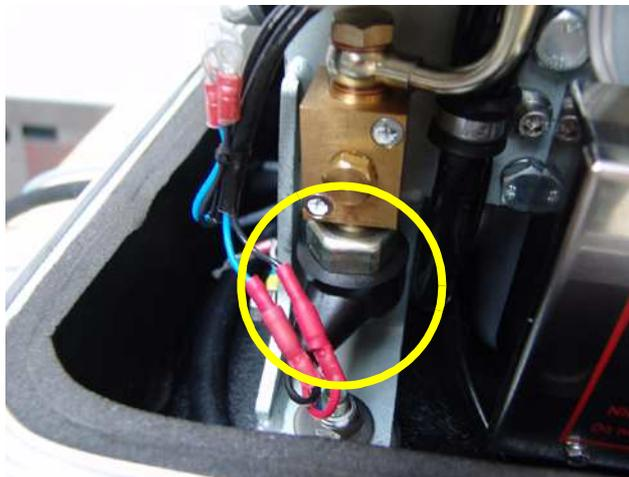
Fig. 4.1-10: Sensor de presión de aceite
