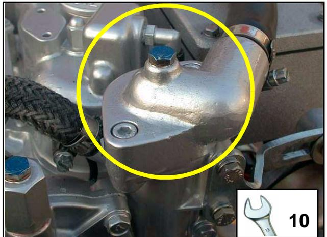
Fig. 5.4.2-3: tornillo de ventilación
