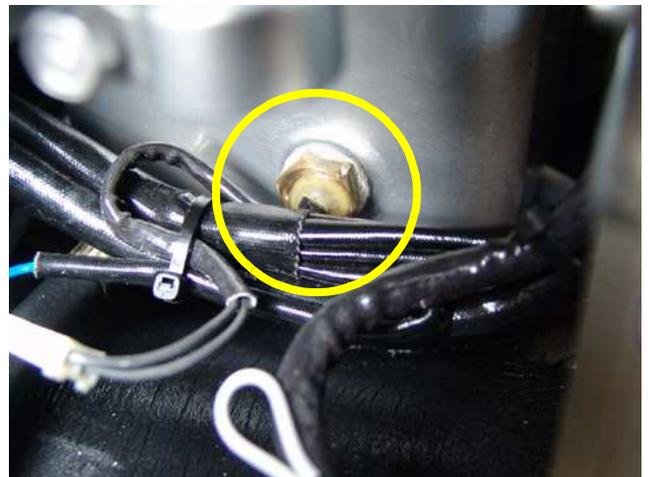
Fig. 3.3.7-9: Termocontacto de la temperatura de aceite
