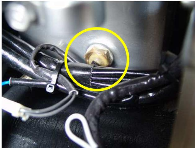
Fig. 4.1-9: Termocontacto de la temperatura de aceite
