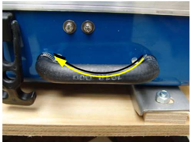
Fig. 3.4.2-3: Conexión del circuito de aireación externo
