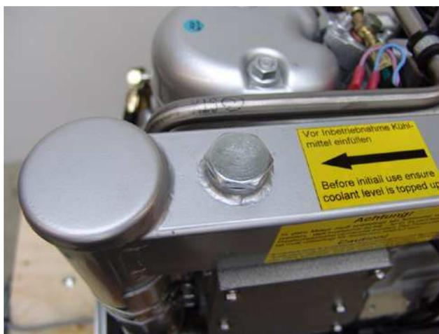
Fig. 3.4.3-1: Tapón de llenado para el agua refrigerante
