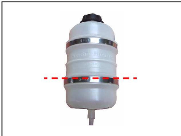
Llenado con agua refrigerante el depósito de compensación externo - Atención: ¡Respetar la marca de "nivel máximo de llenado"! La tapa del recipiente de agua refrigerante externo debe permanecer de modo pasajera abierta (¡sin embargo todos los otros cierres están cerrados!).
