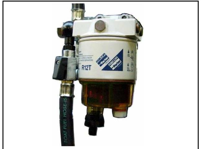
El prefiltro con separador de agua tiene, en su parte inferior, una llave con la cual se puede evacuar el agua que haya bajado.
