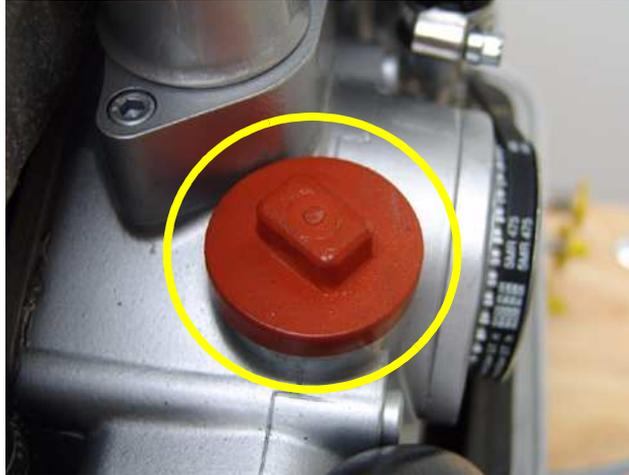
Fig. 3.4.8-1: Tapón de carga aceite de motor
