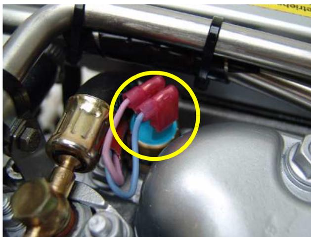
Fig. 3.4.7-1: Termocontacto en la culata
