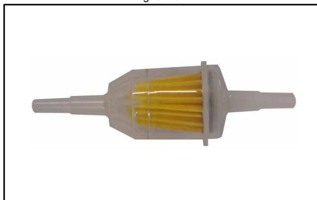
El cambio del filtro depende de la suciedad del combustible, sin embargo se lo debe realizar cada 300 horas de funcionamiento. Antes de la sustitución del filtro se debe desconectar la tubería de alimentación.
