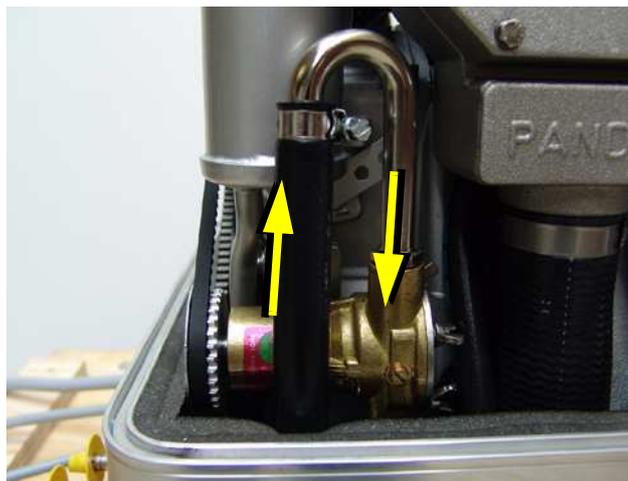
Fig. 3.4.2-2: Propulsor de bomba de agua salada
