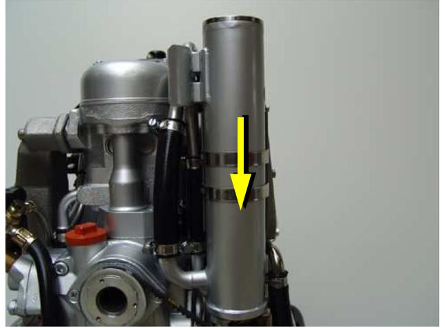
Fig. 3.4.3-2: Intercambiador de calor
