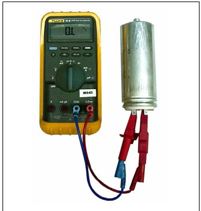
Fig. C.3.2-1: Contrôle des condensateurs
