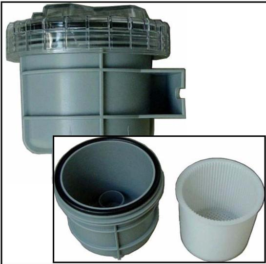
Le filtre d'eau de mer devrait être nettoyé régulièrement. Avant de procéder au nettoyage, il est indispensable de fermer la vanne d'eau de mer. La plupart du temps, il suffit de secouer le panier du filtre. Au cas où des gouttes d'eau sortirait par le couvercle du filtre d'eau de mer, ne jamais étancher ce dernier à l'aide de colle ou de masse d'étanchéité. Recherchez la cause de la fuite. En général, il suffit de remplacer la bague d'étanchéité entre le couvercle et le porte-filtre.
