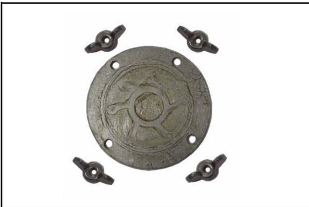
Montez la turbine sur l'arbre de la pompe. (Lors de la réutilisation de l'ancienne turbine, n'oubliez pas de tenir compte du marquage). Fixez le couvercle et remplacez le joint d'étanchéité.
