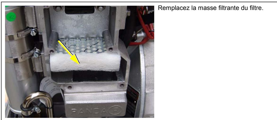
Fig. B.4.1-2: La masse filtrante du filtre
