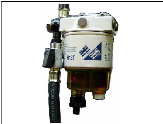
En plus du filtre fin standard, un filtre préliminaire avec séparateur d'eau (pas compris dans la fourniture) doit être installé dans la conduite d'alimentation en carburant, à l'extérieur du cocon insonorisé.
