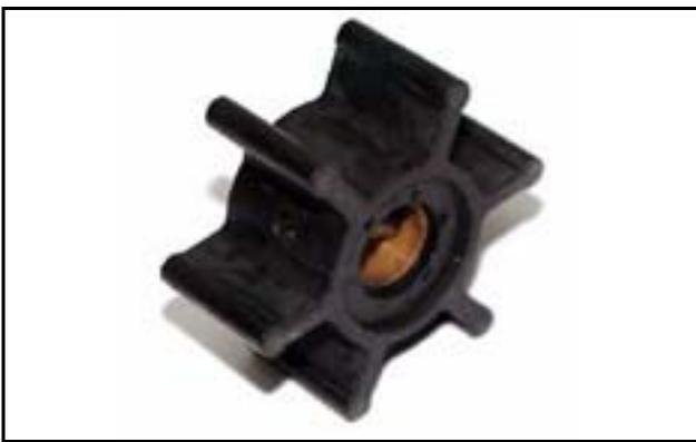
Contrôlez si la turbine présente des dégâts et remplacez-la si nécessaire. Avant de la replacer dans le carter, graissez la turbine avec de la glycérine ou un autre lubrifiant non à base d'huile minérale, par exemple spray silicone.
