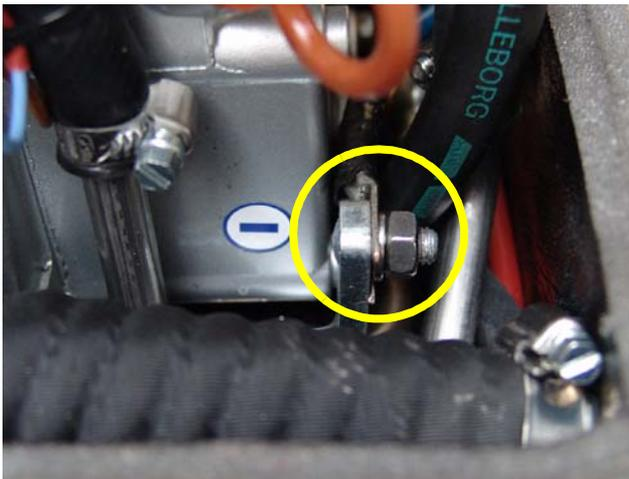
Le câble négatif (-) der la batterie est raccordé au pied du moteur.
