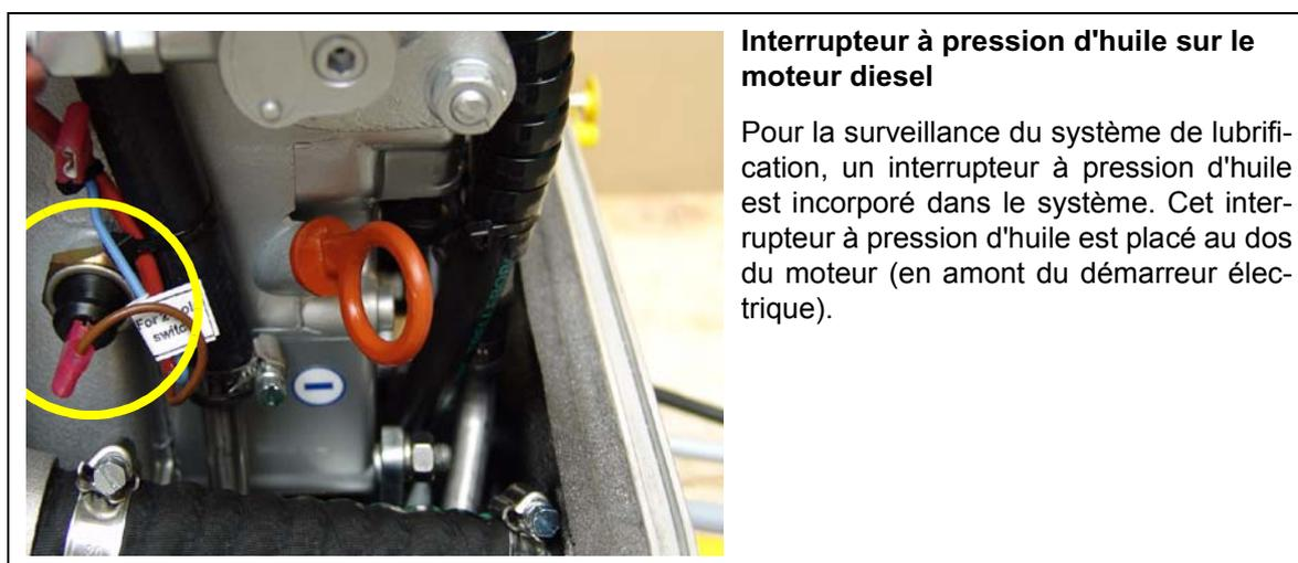
Fig. A.1.0-4: Interrupteur à pression d'huile sur le moteur diesel
