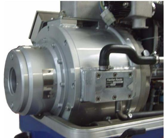
Fig. A.3.1-1: Groupes électrogènes Panda avec accouplement à commande électrique
