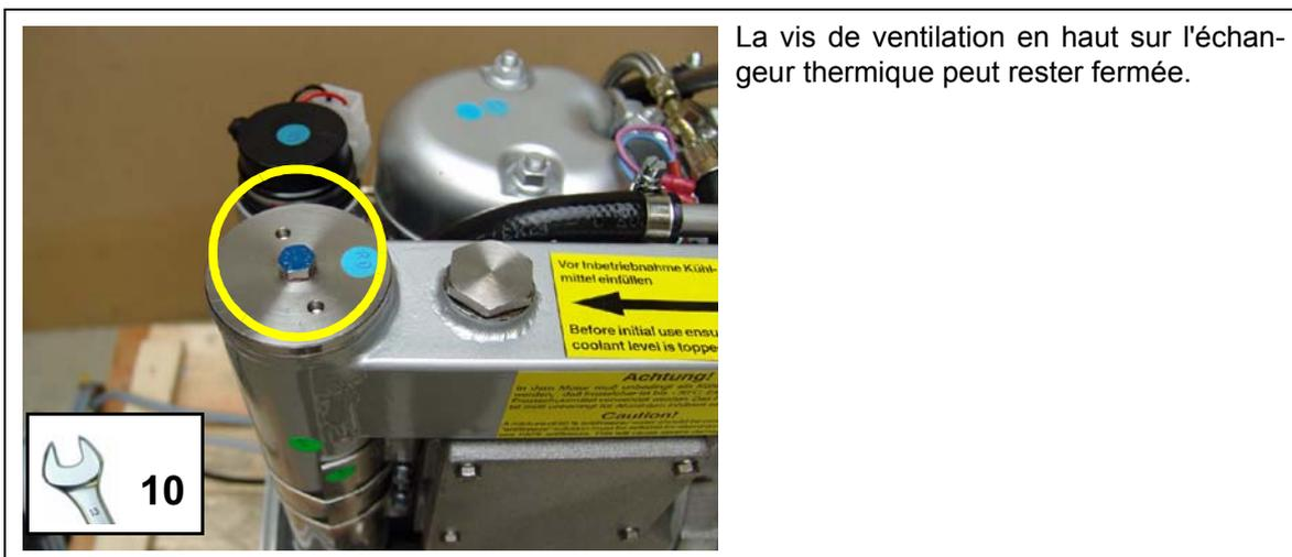
Fig. B.5-5: La vis de ventilation
