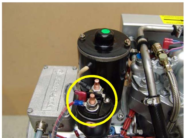
Fig. D.7.1-1: Le câble positif (+) de la batterie
