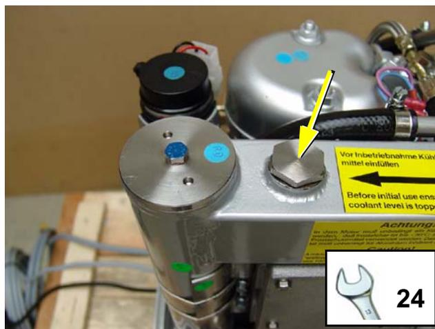
Fig. D.4.3-1: Le couvercle au-dessus du carter coude d'échappement refroidi à l'eau
