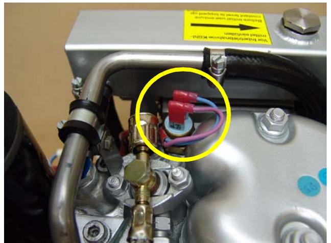
Fig. A.1-1: Commutateur thermique à la tête du cylindre
