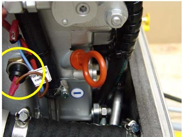
Fig. A.2.7-4: Interrupteur à pression d'huile
